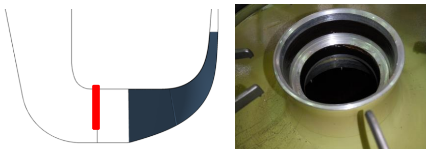
Рис.3. Приемники полного давления: слева – в масштабе в проточной части, справа - фотография установки.
