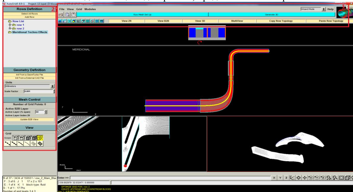
Рис. 1. Скрин окна программы AutoGrid с построенной расчетной сеткой
