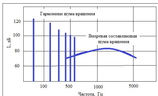
Рис. 1 - Типичный спектр шума воздушного винта
